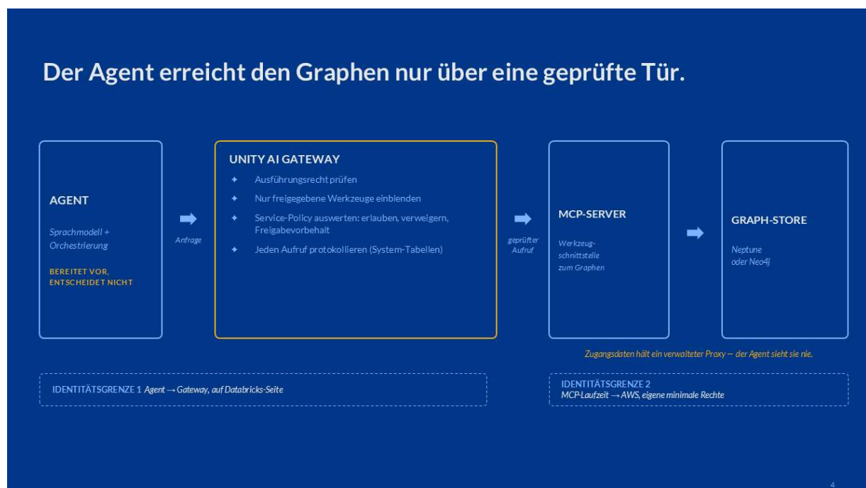
Grafik 4: Der Laufzeitpfad. Der Agent erreicht den Graphen nur über das Gateway, das jeden Werkzeugaufruf prüft und protokolliert.
